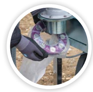
Magnethalter ermöglicht einen sekundenschnellen Wechsel des Staubbeutels.
