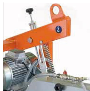
Ein zentraler Kranhaken. Motor mit elektrischer Bremse sichert das rasche Anhalten der Diamanttrennscheibe.
